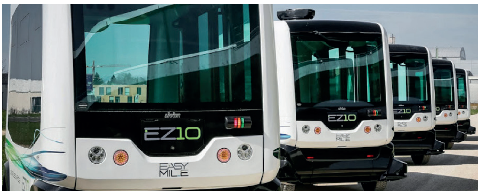
Illustrasjon: Selvkjørende busser beregnet for bruk i urbane områder, i hastigheter inntil 25 km/t. Dette er et av flere produkter i dette segmentet. El-bussene på bildet har en rekkevidde på inntil 14 timer pr lading og benytter eksisterende veinett (foto: Acando).
