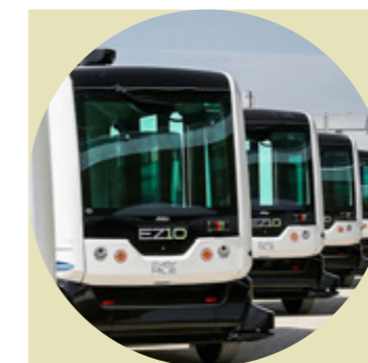
Illustrasjon: Selvkjørende busser beregnet for bruk i urbane områder, i hastigheter inntil 25 km/t. Dette er et av flere produkter i dette segmentet. El-bussene på bildet har en rekkevidde på inntil 14 timer pr lading og benytter eksisterende veinett (foto: Acando).
