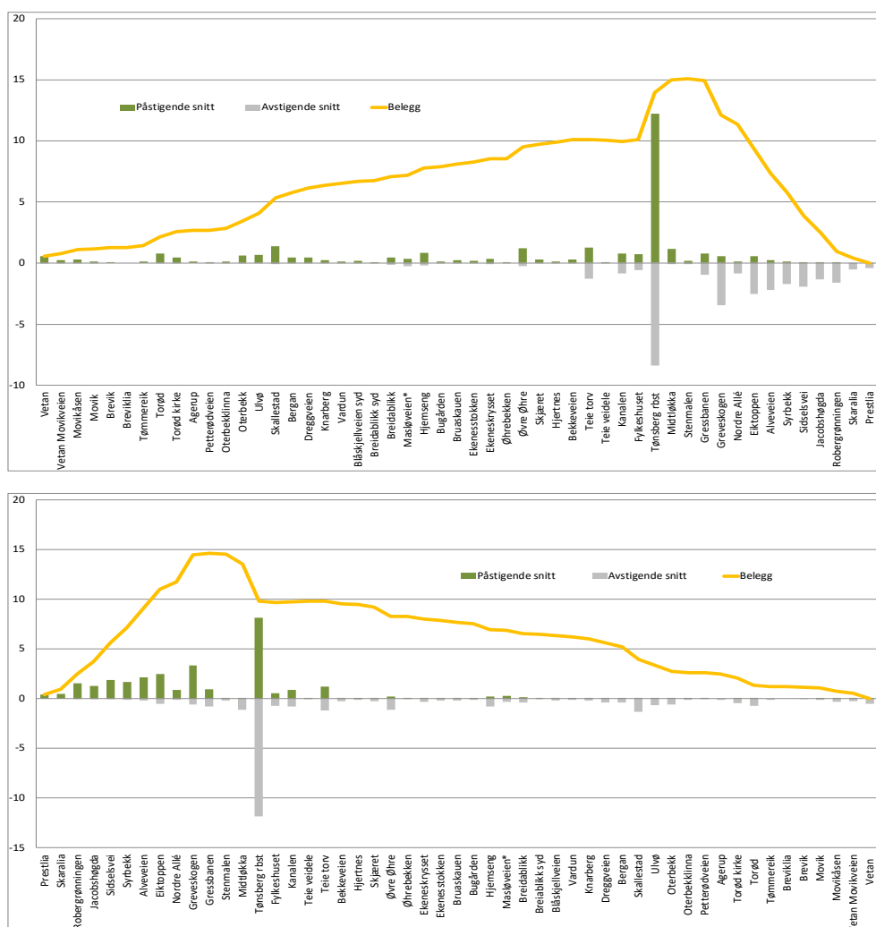
Linjeprofiler for linje 113 retning nord (mot Eik), retning sør (fra Eik) nederst. Gjennomsnittlig passasjerantall over døgnet i november 2015. Grønn søyle = antall påstigende for nevnte holdeplass. Grå søyle = antall avstigende pr holdeplass. Gul kurve viser gjennomsnittlig passasjerbelegg underveis på turen (kilde: VKT).
